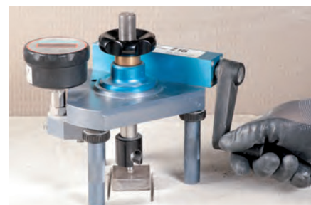
Merjenje oprijema (PULL OFF test)
